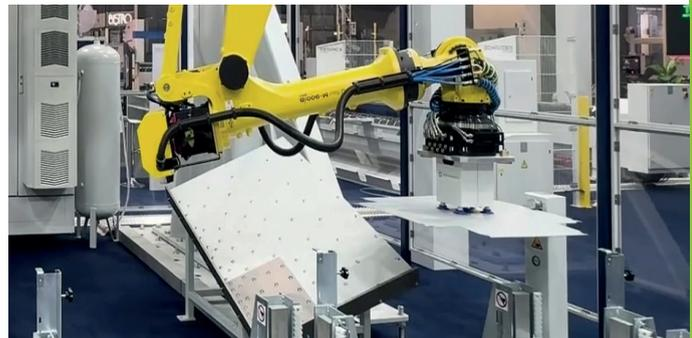
Durch ein einfaches Messsystem kann ausgeschlossen werden, dass der Roboter zwei Bleche aufgenommen hat.
