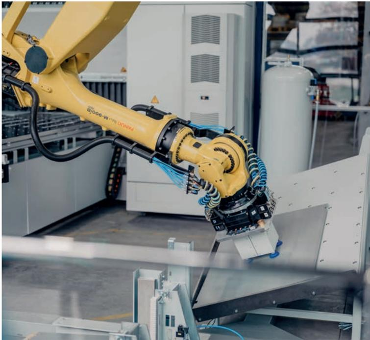
Eingesetzter Fanuc-Roboter: Das Blech wird am Ablagetisch vorzentriert und per Vakuumeinheit angesaugt.
