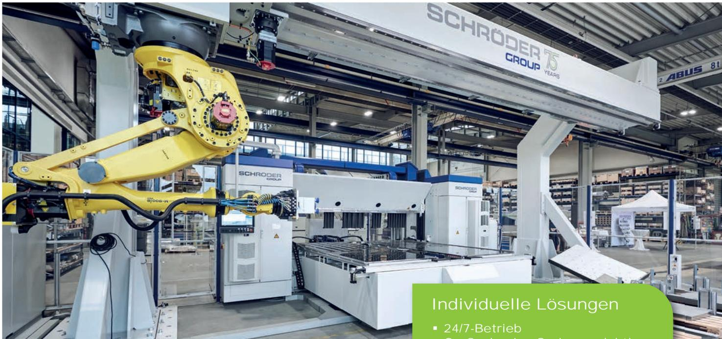
Frontansicht Roboter Handling System mit integrierter motorischer Schwenkbiegemaschine MAK 4 Evolution UD: Nutzlänge x Blechstärke 3200 mm x 6,0 mm
