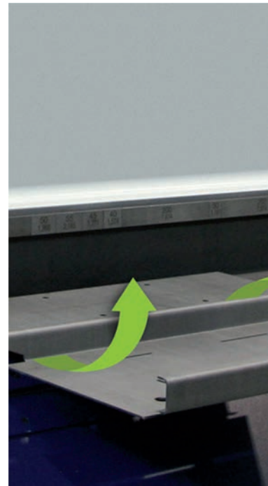
Die Up-and-Down Biegewange erlaubt Gegenkantungen in einem Arbeitsschritt.
