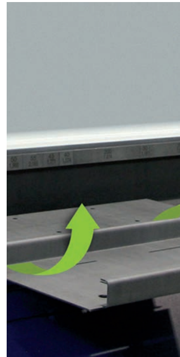
Up-and-Down-Funktion: Gegenkantung ohne Wenden des Blechs
