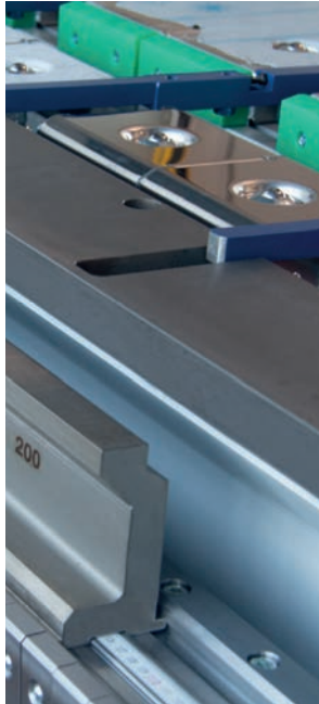
Untervangenschiene mit Fingereinfürungen und Biegeschielen
