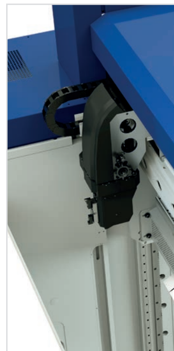
Optional vollautomatischer Werkzeugwechsel an der Oberwange für max. Werkzeughöhe 500 mm
