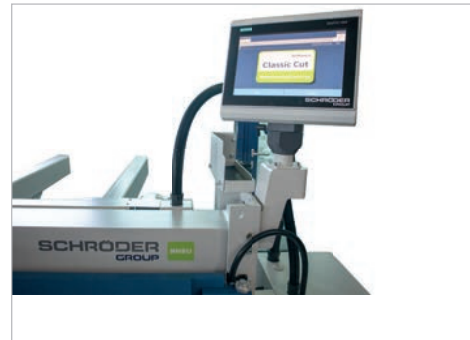
NC - Positionieranschlag Classic Cut mit Touch-Steuerung am drehbaren Panel
