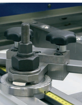
Verlängerter Winkelanschlag mit Gradeinteilung von 0° - 360°
