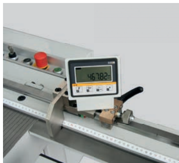
Optional: Verlängerter Winkelanschlag (rechts oder links) mit elektronischem Längensystem incl. seitlichem Klappanschlag auf Linearführung
