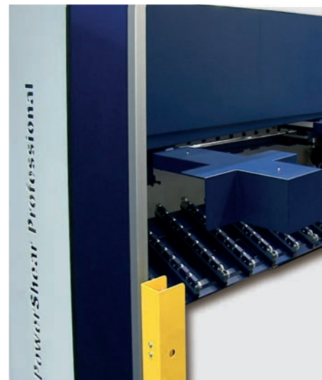
Rückansicht: Motorischer Hinteranschlag und Blechhochhaltevorrichtung sowie Rückraumabsicherung
