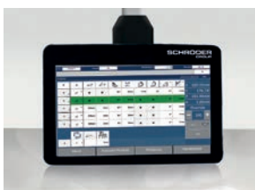
Classic Bend Steuerung am schwenkbaren Panel: eine moderne, alphanumerische Steuerung
